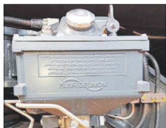
Modernste Schmiersysteme sorgen für eine effektive Verschleiß- und Geräuschreduzierung an Schienenfahrzeugen. Foto (2) Delimon GmbH
