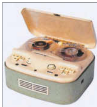
Das RFT-Tonband-Koffergerät KB 100 war das erste Tonbandgerät, das in der DDR in großen Stückzahlen 1959 auf den Markt kam. Hersteller: VEB Fernmeldewerk Leipzig Haus der Geschichte Wittenberg (RR-F)
