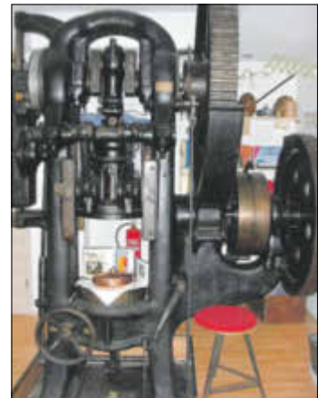
Kniehebel-Tiefziehpresse, Druckkraft 120 T aus dem Jahr 1927.
